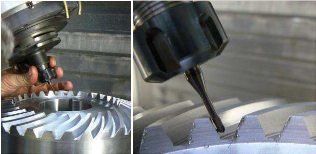
fig. 8 : steel spiral wheel milling
